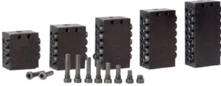
Die SSVD-Verteiler sind von der Funktionsweise ähnlich der SSV-Verteiler. Die Fördermenge ist jedoch paarweise dosierbar. Die Dosierung erfolgt innerhalb der Verteilerblöcke durch Dosierschrauben, die vormontiert oder lose geliefert werden können.
